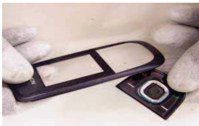
7) Remove the function key.
